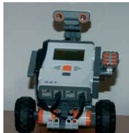
7. irudia. Lego MindStorms NXT-rekin egindako robot sinplea.
